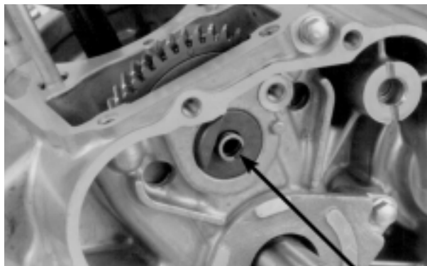
MOLA DA ÁRVORE DE COMANDO EIXO DA ENGRENAGEM DE COMANDO
